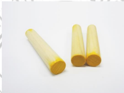
ภาพที่ ก-1 ตัวอย่างวัสดุเม็ดที่ทำจากไม้อีโนกิรูปทรงกระบอก
