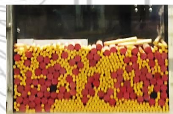
ภาพที่ 4.3 การเคลื่อนที่ของวัสดุเม็ดผ่านวัสดุผนังอะคริลิก (ก) 1 วินาที (ข) 102 วินาที (ค) 28 วินาที (ง) 483 วินาที (จ) 600 วินาที
