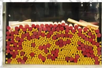
ภาพที่ 4.3 การเคลื่อนที่ของวัสดุเม็ดผ่านวัสดุผนังอะคริลิก (ก) 1 วินาที (ข) 102 วินาที (ค) 28 วินาที (ง) 483 วินาที (จ) 600 วินาที
