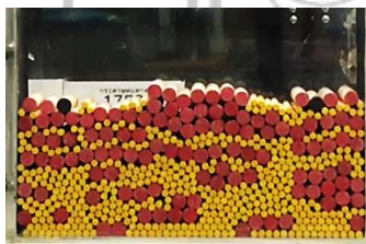
ภาพที่ 4.3 การเคลื่อนที่ของวัสดุเม็ดผ่านวัสดุผนังอะคริลิก (ก) 1 วินาที (ข) 102 วินาที (ค) 28 วินาที (ง) 483 วินาที (จ) 600 วินาที
