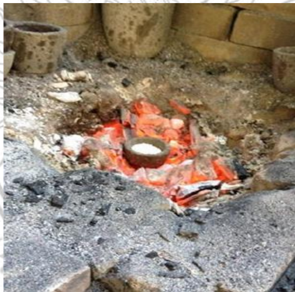
ภาพที่ 2.7 เบ้าหลอมในเตาเผา
