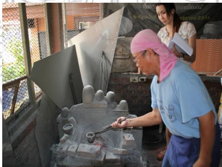
ภาพที่ 2.5 นำเข้าหลอมไปวางไว้บนเตาเผา
