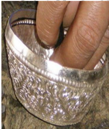
ภาพที่ 2.18 การตอกกลดลายละเอียดจากด้านนอกด้วยค้อน เหล็กสี่เหลี่ยม
