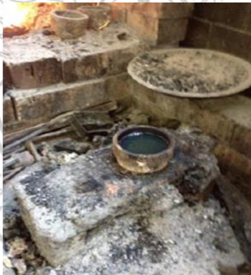
ภาพที่ 2.9 รางเทรูปทรงกลม (เบ๊ง) ขณะยังไม่ได้จุดไฟ
