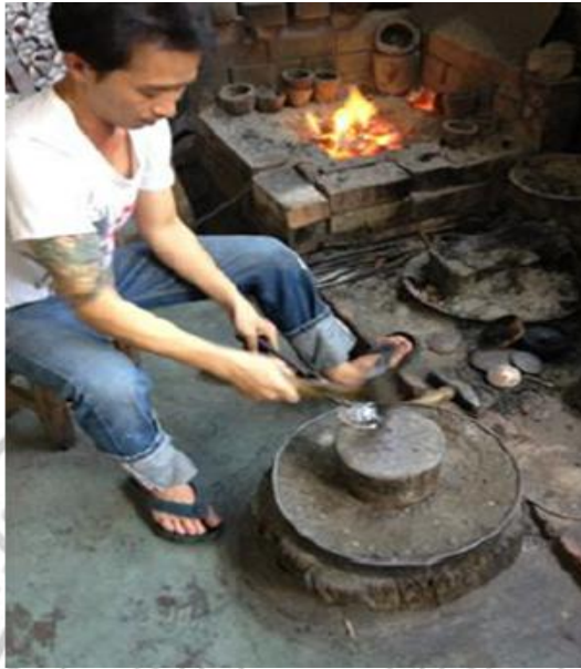
ภาพที่ 2.15 การขึ้นรูปโดยใช้ค้อน
