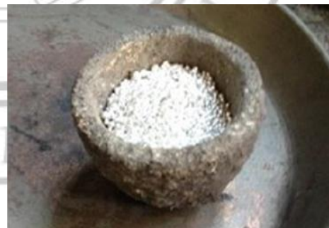
ภาพที่ 2.3 เม็ดเงินในเบ้าหลอม
