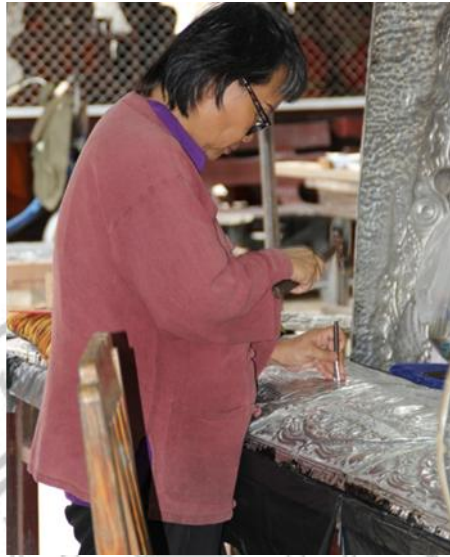
ภาพที่ 2.22 การสลักตามแบบที่ต้องการ โดยวิธีการตอกด้วยส่วขนาดต่างๆ
