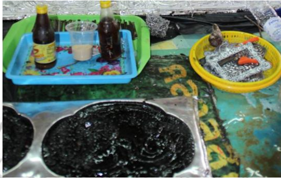
ภาพที่ 2.17 ชั้น รองรับเครื่องเงินที่จะตอกหรือสลักกลดลาย
