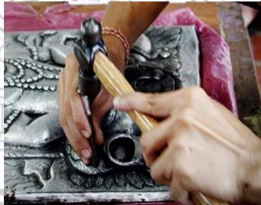
ภาพที่ 2.18 การตอกกลดลายละเอียดจากด้านนอกด้วยค้อน เหล็กสี่เหลี่ยม
