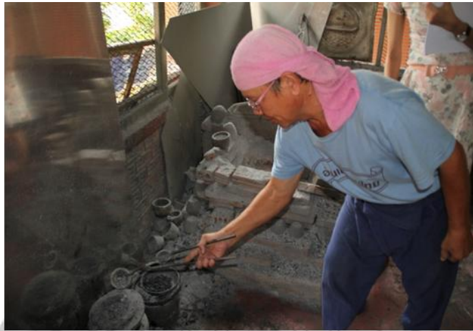
ภาพที่ 2.10 เทเนื้อเงินลงไปในรางเท
