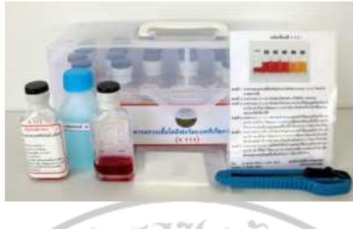
ภาพที่ 2.1 ชุดตรวจสอบโคลิฟอร์มแบคทีเรียในสิ่งแวดล้อม (SI-2)
