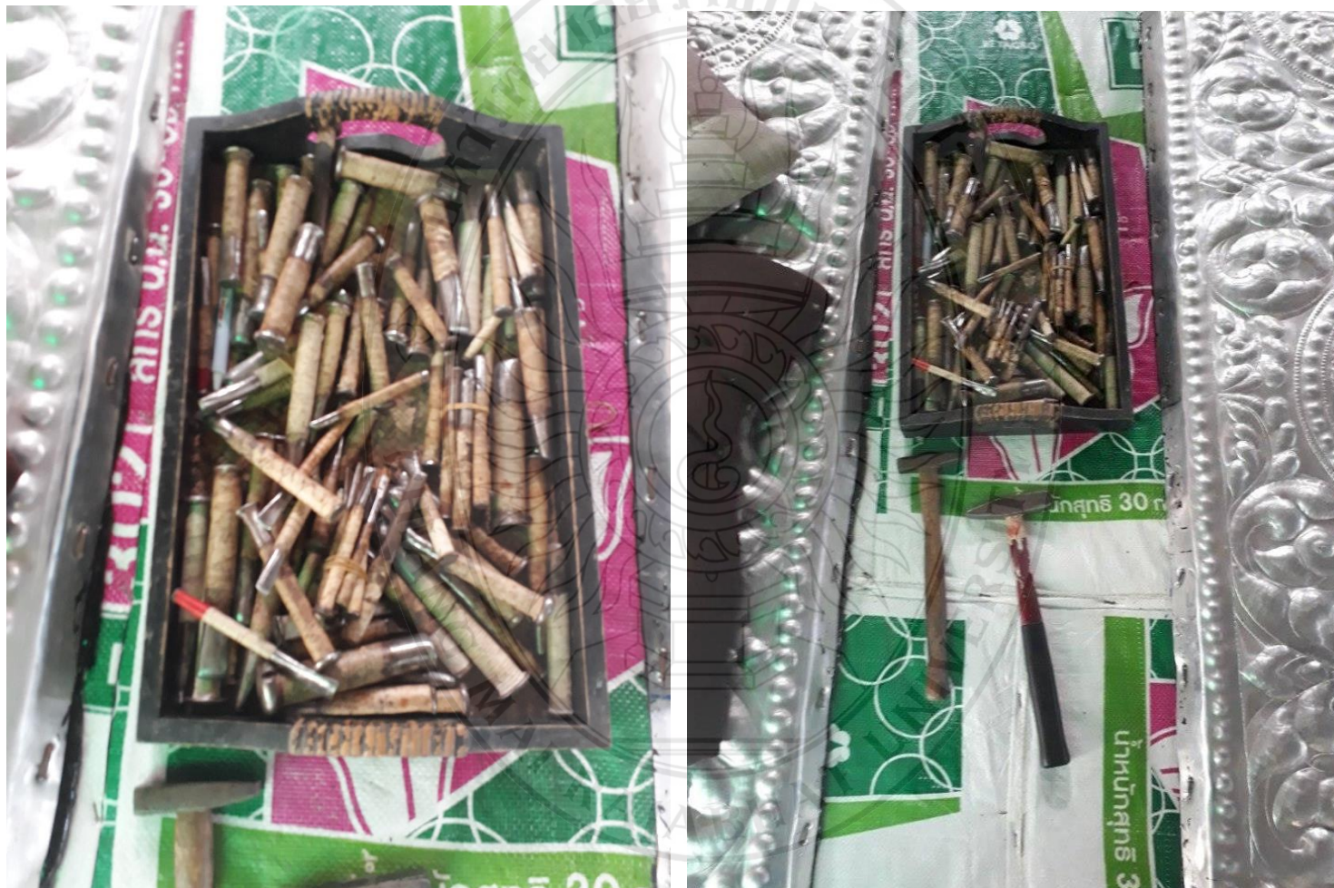
ภาพเครื่องมือในการตุ๋นลาย หรือการตีแผ่นโลหะ
