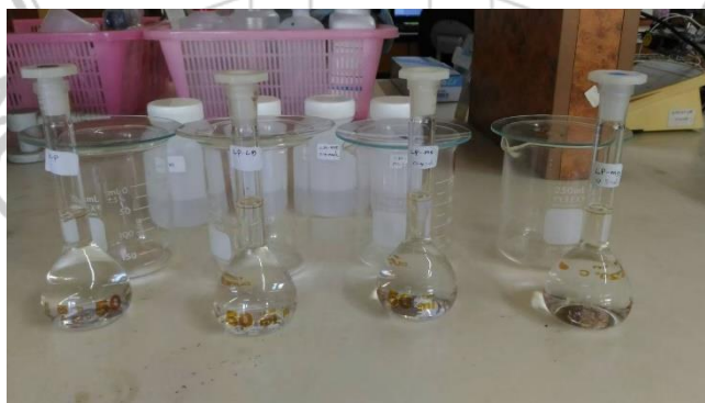
ภาพที่ 3.1 ภาพการย่อยตัวอย่างน้ำก่อนการนำไปวิเคราะห์หาปริมาณโลหะ
