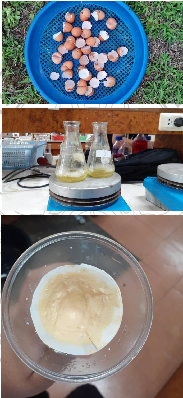
ภาพที่ 3.3 ภาพการเตรียมเปลือกไข่และการสารประกอบแคลเซียมไฮดรอกไซด์ ( \text{Ca}(\text{OH})_2 )
