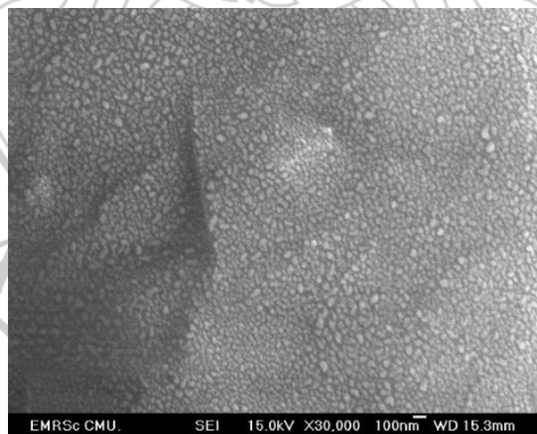
ภาพที่ 4.13 โครงสร้างนาโนเกรนของชิ้นงานตัวอย่างที่เผาซินเตอร์ด้วยวิธีการแบบ rate-controlled sintering ที่ อุณหภูมิ 1200^{\circ}\text{C}
