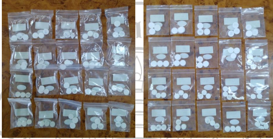
ภาพที่ 4.10 ตัวอย่างชิ้นงานหลังเผาซินเตอร์ที่อุณหภูมิ 1150 1200 1250 และ 1300°C เป็นเวลา 3 ชั่วโมง ในเตาไฟฟ้า
