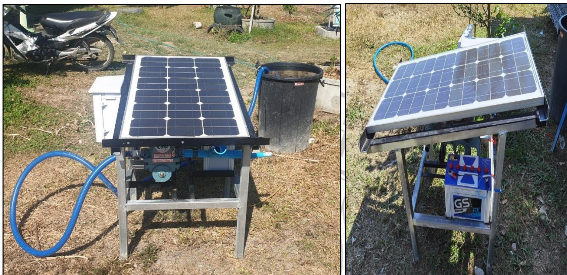
ภาพที่ 4.3 ระบบสูบน้ำพลังงานแสงอาทิตย์
