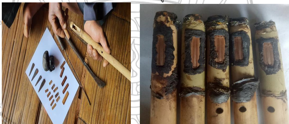
ภาพที่ 4.19- 4.20 การใส่ลั่นปี่กับท่อเสียงไม้ไผ่ ปิดด้วยชันรงค์เชื่อมกันให้สนิททุกท่อ
