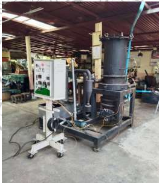
ภาพที่ 4.6 การวัดค่าอุณหภูมิภายในเตา 4 จุดเพื่อหาค่าความร้อนสูงสุด
