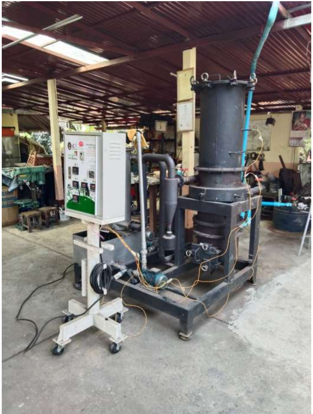
ภาพที่ 7 ระบบเตาแก๊สซีฟิเออร์แบบไหลลงที่ใช้ในการทดสอบ
