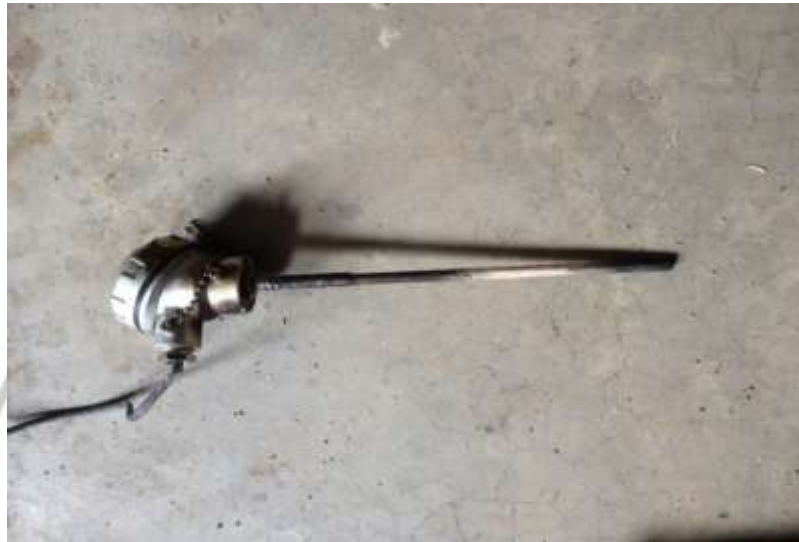
ภาพที่ 3.2 เทอร์โมคัปเปิลชนิดเค (Type K Thermocouple)
