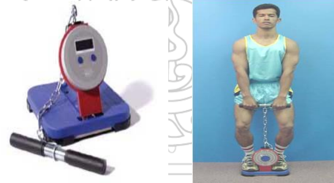
ภาพที่ 13 การวัดแรงเหยียดขาและอุปกรณ์
