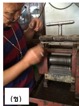
รูป 3.2 แสดง (ก) บล็อกหล่อเงินและ (ข) การนำเงินเข้าเครื่องรีดเงิน
