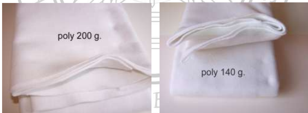
ภาพที่ 5.12 แผ่นใยโพลีเอสเตอร์อัดแน่นชนิดบาง 140g และ 200g
