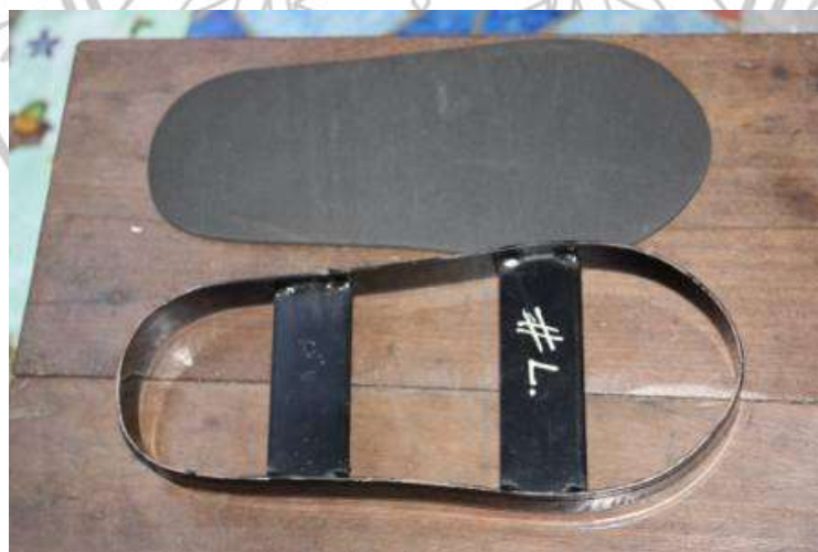
ภาพที่ 5.10 บล็อกเหล็กตัดพื้นหนังรองเท้า ของกลุ่มตัดเย็บบ้านดอกแดง
