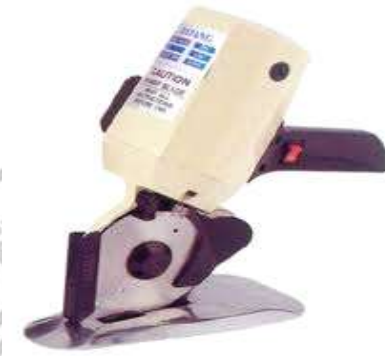
ภาพที่ 5.9 เครื่องตัดผ้าขนาดใบมีด 4 นิ้ว ของกลุ่มตัดเย็บบ้านดอกแดง
